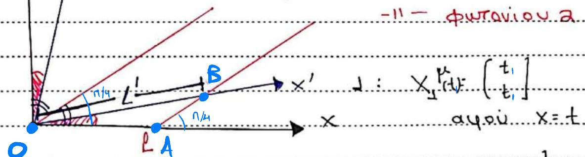
$$x_1^\mu(t_1) = \begin{bmatrix} t_1 \\ L+t_1 \end{bmatrix}$$
